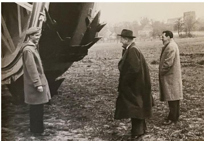
Der **Bagger 104** wurde erstmals eingesetzt beim Grubenanstich am **28.9.1953** in der Grube Victor. Der 417 t schwere Koloss verfügt über eine Baggerschaufel von 6,5 Meter Durchmesser. Er wurde eingesetzt, um den Mutterboden abzulagern. Dieser Boden wurde dann später zur Rekultivierung verwendet. Anschließend wurde
